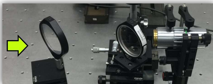
Rys. 34. Zdjęcie układu dwóch klinów w laboratoryjnym układzie FDHM.
